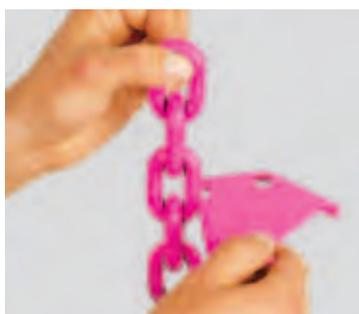
Controllo usura sezione Ø del diametro
