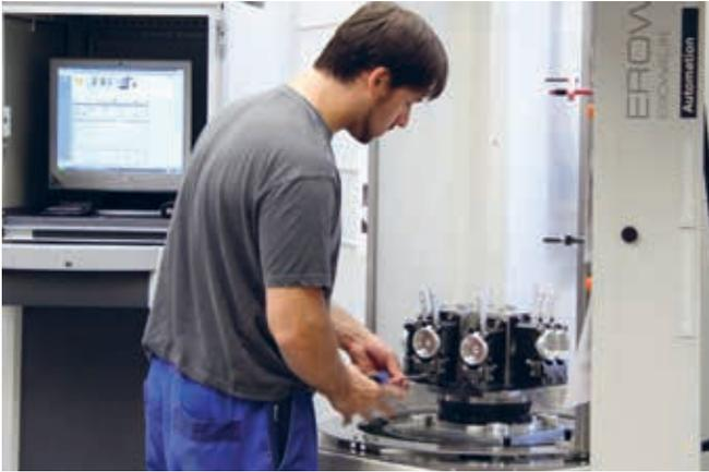
I pezzi pronti vengono automaticamente portati alla stazione di attrezzaggio. Il serraggio di nuovi elettrodi grezzi viene supportato graficamente.
