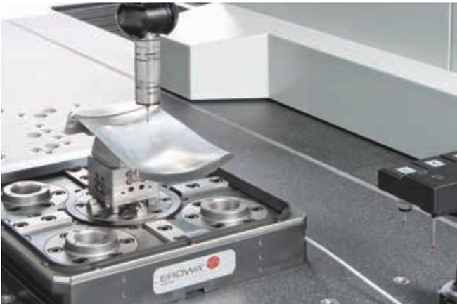
**CMM Qi** | I punti zero vengono rilevati sulla macchina di misura in modo estremamente semplice. Attraverso l'interfaccia integrata i dati vengono assegnati ai pezzi.
