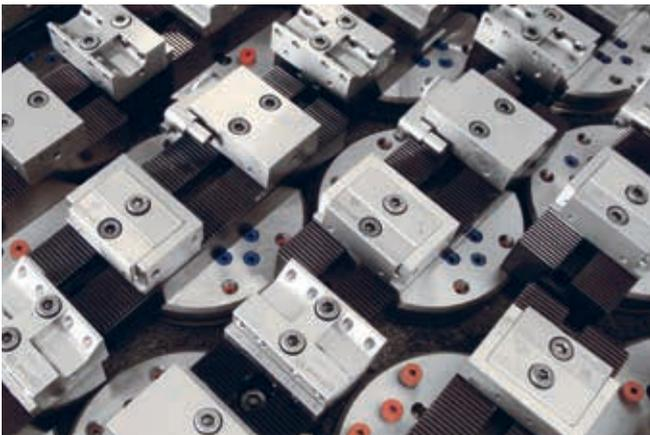
Attrezzaggio e preparazione mentre la cella di produzione continua a produrre. Non ci sono tempi di attesa. EWIS™ Chip provvede all'identificazione.
