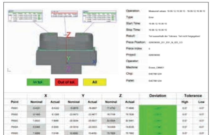
I protocolli di misurazione vengono importati come PDF 3D. In questo modo si ha anche una rappresentazione grafica dei punti di misurazione controllati.
