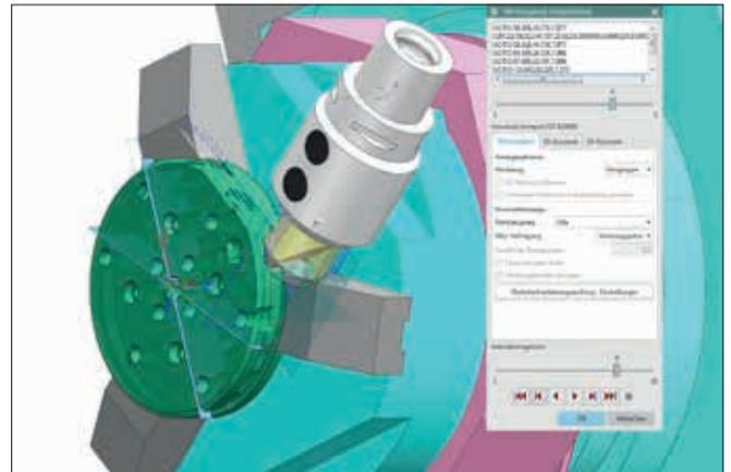
**CAM** | I dati CAD vengono importati nel CAM tramite interfaccia. I programmi CNC vengono generati e resi disponibili.
