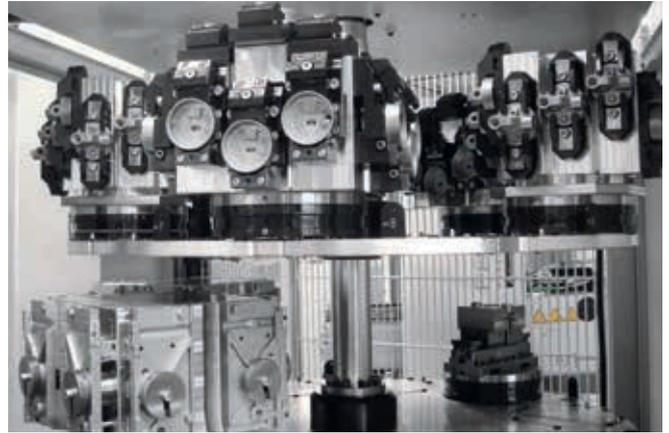
Più dispositivi su un pallet vengono gestiti tramite Fixture Manager. La posizione di un pezzo serrato viene memorizzata automaticamente. Il sistema di identificazione provvede ad un'assegnazione corretta dei dati.
