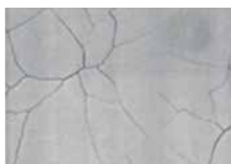
Possibili effetti di una lubrorefrigerazione insufficiente
