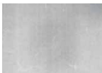
Superficie ottimale ottenuta con una refrigerazione corretta
