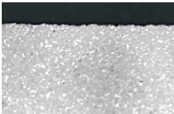
Superficie ottenuta mediante un numero sufficiente di passaggi di finitura
