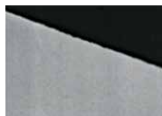
Superficie ottimale ottenuta con una refrigerazione corretta
