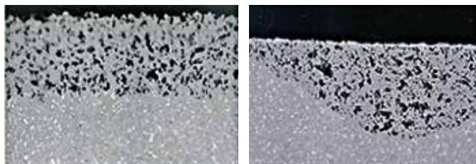
Esempio di depauperamento del cobalto in superficie provocato da corrosione
