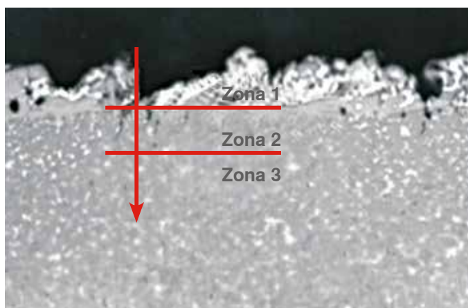
Superficie di un pezzo in metallo duro dopo il taglio di sgrossatura
